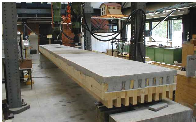
Figure 7 : Essai à la rupture d'une poutre mixte, élément D-Dalle® pour une portée de 15 m
